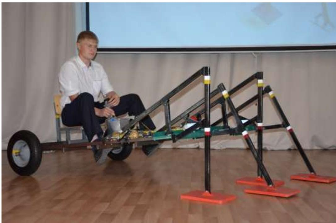
Рисунок 3 Действующая модель стопоходящей машины
