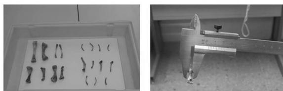
В ходе работы измерил диаметр трубчатых костей, и ширину и толщину плоских костей в разных частях штангенциркулем. Рассчитал площади поперечного сечения образцов.
