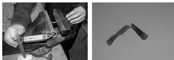
Вычислили разрушающее напряжение для испытуемого материала (предел прочности). Результаты измерений и вычислений занесли в таблицу по каждому типу костей.
